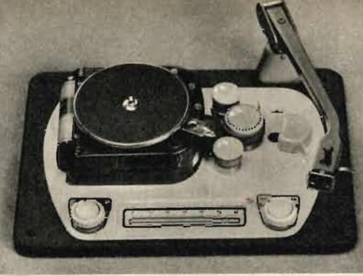
Abb. 18. Tefifongerät mit Schallplattenzusatz
