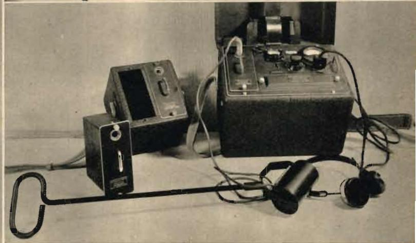
← Röhrenloser Strom- und Spannungsmesser mit Tastkopf; enthält Kristalldioden (VEB Funkw. Erfurt)
