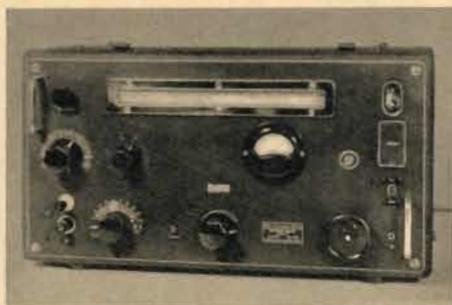
Induktivitätsmeßgerät Typ „273“; Meßbereich 0,1  $\mu$ H ... 1 H; Meßunsicherheit etwa  $\pm 2\% \pm 0,02 \mu$ H
