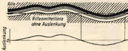
Abb. 1. Hier wird veranschaulicht, was unter dem Begriff „Rillen-Auslenkung“ zu verstehen ist
