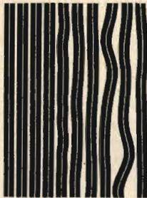
Abb. 5 (links außen im Titel). Rillen mit konstantem mittlerem Abstand nach dem bisherigen Aufzeichnungsverfahren
