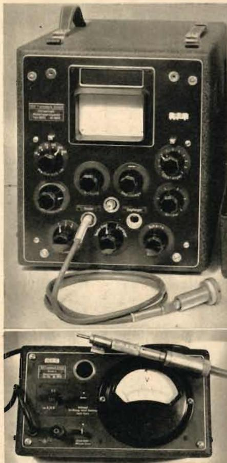
Links: Ultraschall-Materialprüfgerät (VEB Funkwerk Erfurt); rechts: Ultraschall-Generator „9105“, Ultraschall-Verzinnungsgerät „9104“ und Ultraschall-LötKolben (VEB Funkwerk Erfurt)
