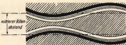
Abb. 2. Gegenläufige Auslenkungen. Der Rillenabstand muß jeweils so groß sein, daß kein Überschneiden der Rillen vorkommen kann
