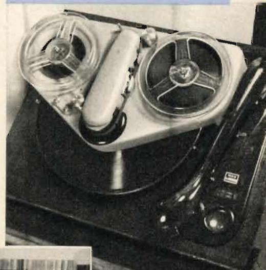
Magnetband - Aufsetzgerät „Toni“ für 19,05 cm/s Bandgeschwindigkeit. Der zweistufige Verstärker ist unter der Chassishaube eingebaut; der Netzteil sitzt in einem gesonderten Kästchen (Funkwerk Leipzig)
