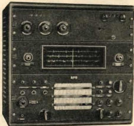
25-W-Schiffsverstärkerzentrale (Funkwerk Kölleda)
