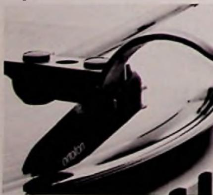
Einbau von MC-Systemen (Beispiele: Braun PS 500/PS 550, Telefunken S 500/S 600): Die umfangreiche Elektronik ist in diesen Plattenspielern nicht genügend abgeschirmt, so daß Störspannungen induziert werden. Bei solchen Geräten hilft auch das Verändern der Erdung nichts. Auf die Tatsache, daß sich nicht alle Plattenspieler für den Einbau dynamischer Tonabnehmer eignen, wird in Testberichten nicht genügend hingewiesen.
