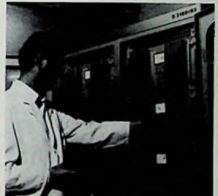
Wie AEG-Telefunken mitteilt, ist dieser 3-kW-UKW-Sender für den Hessischen Rundfunk bisher der weltweit erste Sender dieser Leistungsklasse, der als Verstärkerelemente einzig und alleine Halbleiter enthält.
