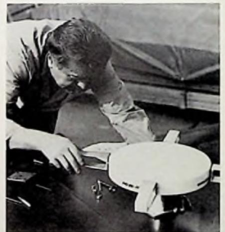
Die Rundempfangsantenne HD 36 R soll auch in fahrenden Autobussen guten Fernsehempfang ermöglichen. (Kathrein)
