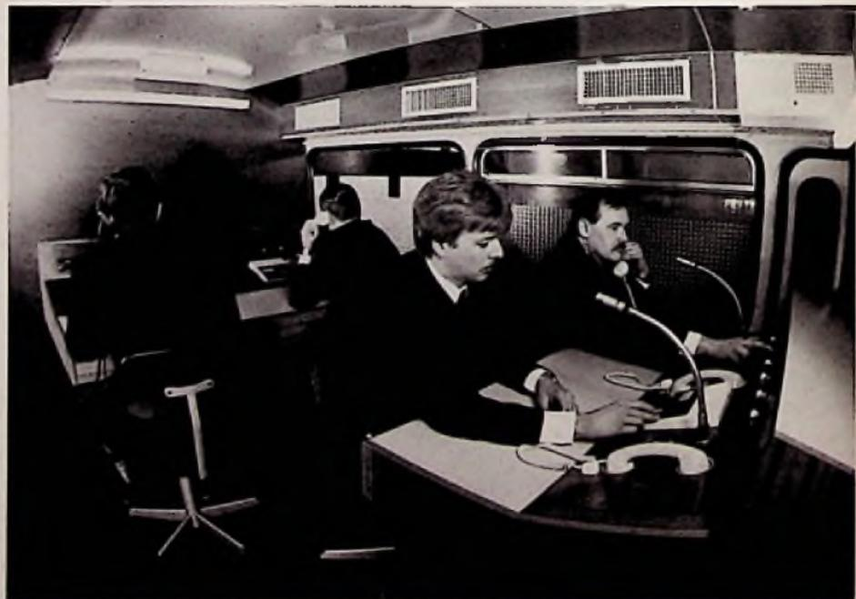
Bild 3. Fernmelderaum des ELW 3 mit dem „Kommandotisch“ (hinten) und dem „Sichertisch“ (vorne)
