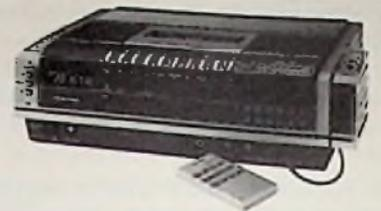
Bild 8. Zwei zusätzliche Videoköpfe befähigen diesen VHS-Recorder V-8700 von Toshiba zu einem Standbild ohne Störzone
