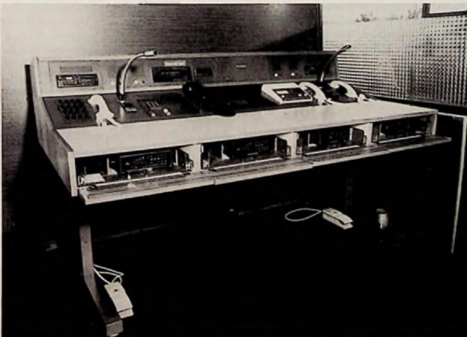
Bild 4. Kommandotisch; in den vier Schubfächern je ein Funkgerät
