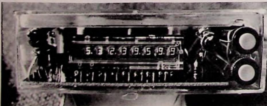
Bild 1. Stoppuhr mit Zwischenzeitspeicher (Frontansicht)
