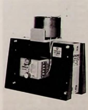
Besondere Merkmale der TH 2426 sind die große Bandbreite (85 MHz), das robuste, mechanische Abstimmensystem mit genauer Anzeige der Abstimmung der Resonatoren, die Druckluftkühlung und die Fokussierung mit Permanentmagneten.
