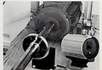
Bild 1: Berührungslose Meßübertragung von rotierenden Wellen und deren Speisung über Lichtstrahlen
