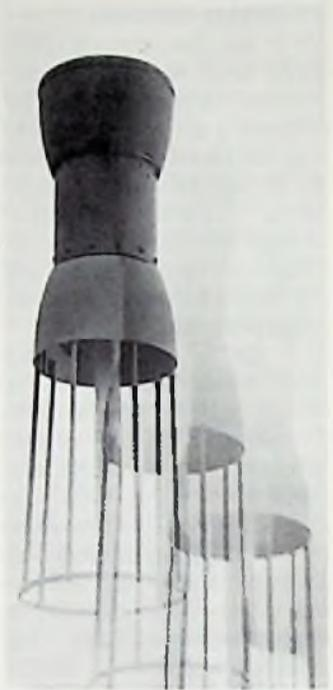
**Bild 1: Breitbandrundstrahler für 100-1300 MHz**
