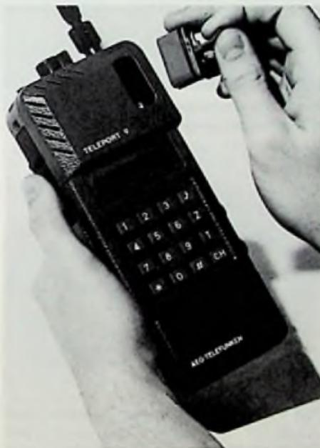
Bild 2: Handfunk-Sprechgerät „Teleport 9“ mit dem Codierstecker Multiprogrammer (AEG-TELEFUNKEN-Pressbild)
