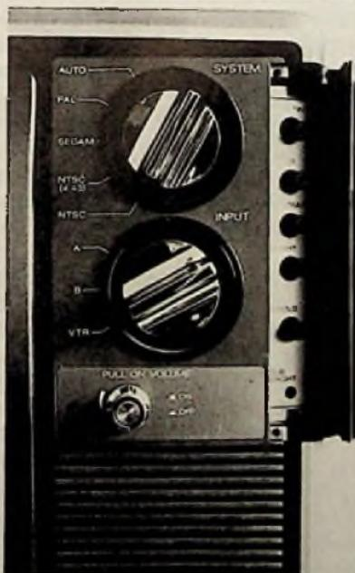
Bild 9: Bedienfeld eines 4-Normen-Farbmonitors (JVC VM 14 PSN) mit automatischer oder manueller Systemwahl
