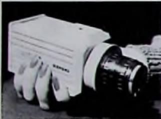
**Bild 1: Nützliche Überwachungskamera mit CCD-Sensor** (Siemens-Pressebild)
