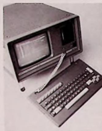
Bild 1: Spezialcomputer zum Testen der Eigenschaften von ISDN-Netzen
