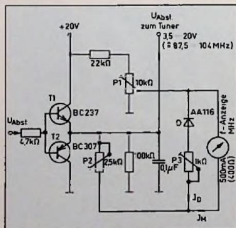
Bild 1: Schaltungsauszug der Frequenzanzeige
