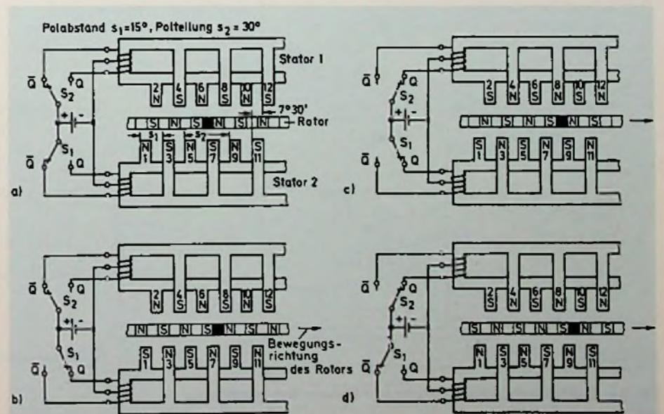
Bild 9.3: Bewegung eines Rotorpunktes bei den verschiedenen Schalterstellungen in Bild 9.2
