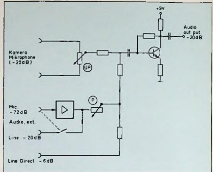
**Bild 7:** Signalverlauf der angelegten Audiosignale (Mono)
