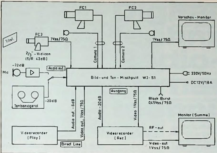
Bild 3: Kombinationsmöglichkeiten des WJ-S1 mit externen AV-Geräten
