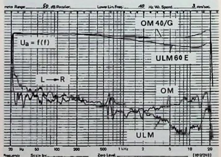
**Bild 5:** Die Höhensenke des älteren ULM 60E wird vom neuen OM 40/Gold „aufgefüllt“. (15 mN; 47 kΩ/123 pF; JVC 1007)
