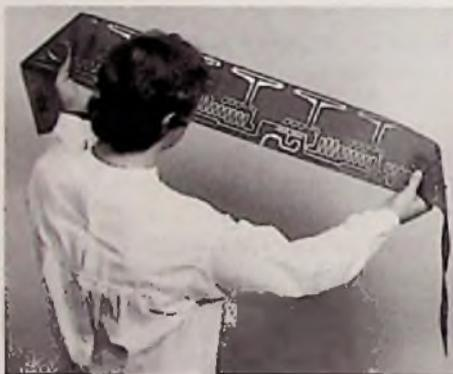
Bild 1: Für diese 1,6 m lange flexible gedruckte Schaltung in einer Radaranterie von Cossor wird Du Pont „Kapton“ Polyimidfolie als Trägermaterial verwendet
