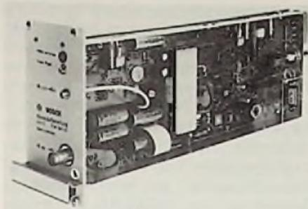
**Bild 8: TV-Kanalaufbereitungsmodul für Satellitenempfang** (Bosch-Pressbild)
