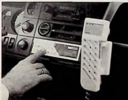
Bild 7: Praktische Ausführung des Mobilfunktelefons im DIN-Ausschnitt für das Autoradio. Bedient werden kann aber auch vom Hörer aus (AEG-Pressbild)
