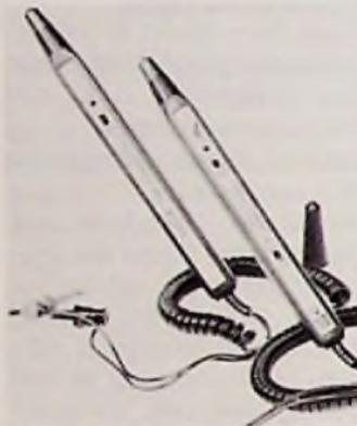
Bild 1: Pulsgeber und Logik-Prüfer zur Untersuchung an Digitalschaltungen
