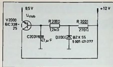
Bild 1: Stabilisierungsschaltung zum Erzeugen der 8,5-V-Schalt-Spannung
