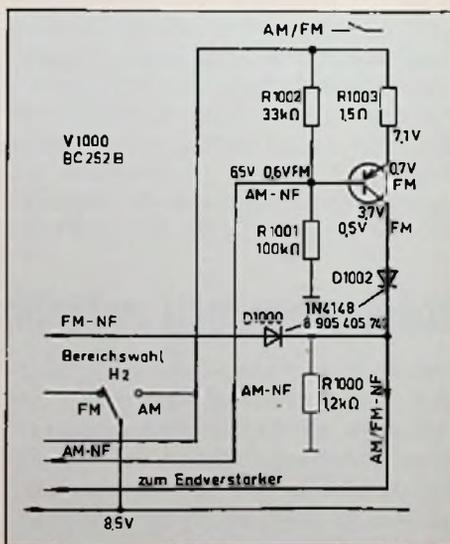
Bild 2: Schaltungsauszug zur Niederfrequenzumschaltung zwischen AM und FM
