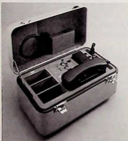
Bild 12: Optisches Feldtelefon für Glasfasernetze (kabelmetall electro-Pressbild)
