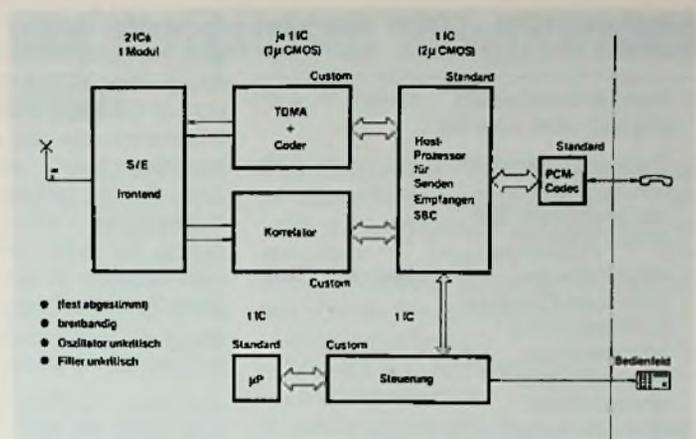
Bild 11: Technologie des Funktelefons
