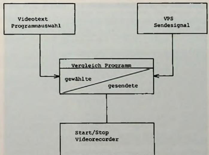
Bild 2: Prinzip der VPS-Programmierung durch Videotext
