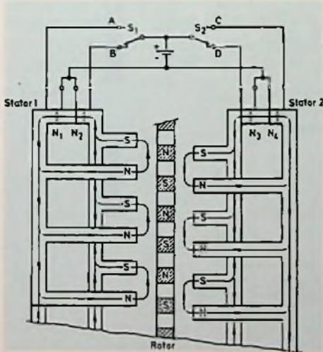
Bild 9.2: Abgewickelter Schnitt durch einen modernen vielpoligen Schrittmotor
