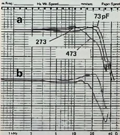
Bild 6: a) Der Einfluß der Parallelkapazität  $C_L$  zum 47 k $\Omega$ -Abschlußwiderstand beim OM 40/Gold, b) Auswirkungen unterschiedlicher Kabelkapazitäten auf die Höhenwiedergabe bei zwei verschiedenen Plattenspielern mit dem OM 40/Gold unter gleichbleibenden Abtastbedingungen
