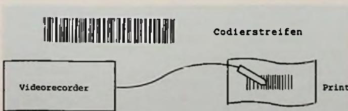
Bild 1: VPS-Programmierung durch Strichcode
