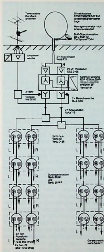
Bild 1: Beispiel eines gemeinsamen Breitbandverteilkonzeptes für Satelliten- und terrestrische Hör- und Fernsehsignale (Hirschmann-Presebild)
