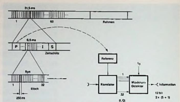
**Bild 9: Signalstruktur und Prinzip der Signalverarbeitung**
