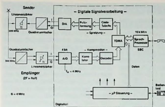
Bild 10: Blockschaltung des Mobilgeräts
