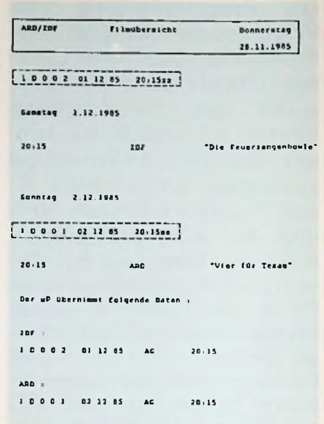
**Bild 5: Speicherung von VPS-Programmen verschiedener Programm-Quellen**
