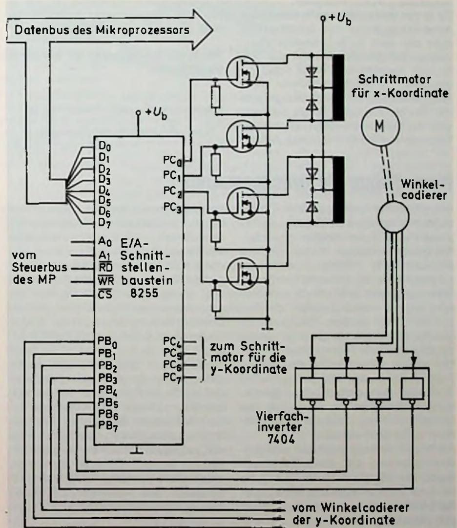
Bild 9.8: Anschluß eines Schrittmotors an den Bus eines Mikroprozessors
