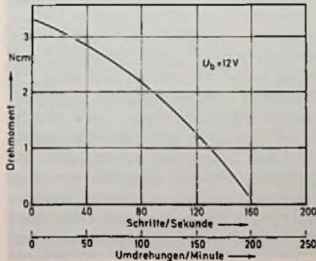
Bild 9.6: Abhängigkeit des Drehmomentes eines Schrittmotors von der Schrittfrequenz
