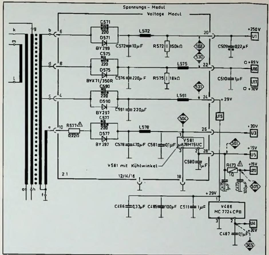
Bild 1: Der fehlerhafte Spannungsregler-IC V581 verursachte das Zittern des Bildes
