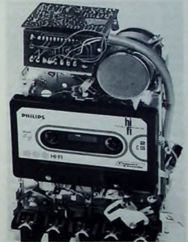
Bild 4 (unten). Fühler für Aufnahmesperre (links) und Bandsortenumschaltung
