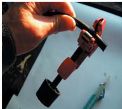
photo 3 : dénuder au moyen d'un petit coupe tuyau
