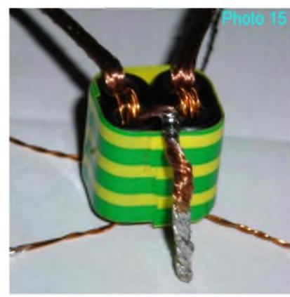
Détail de la tresse et la torsade de 2 morceaux de tresse point milieu des enroulements P1 et P2, point d'alimentation en +13,8 volts.
