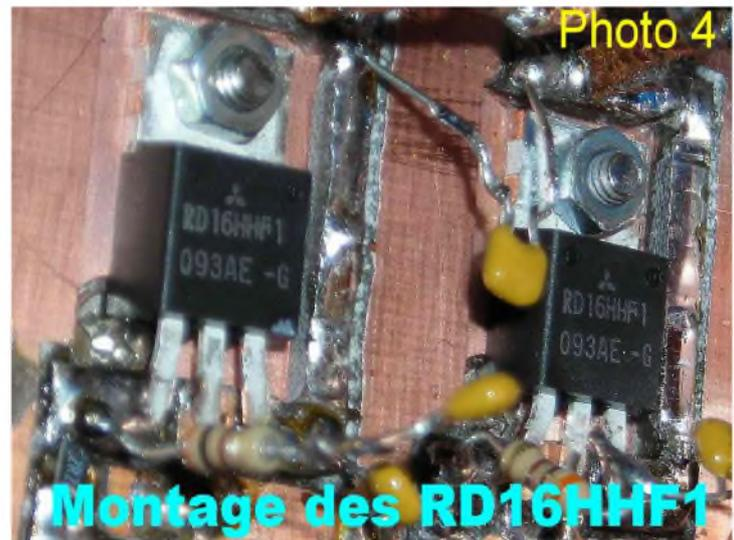
Le radiateur du CPU présente une surface d'échange thermique en cuivre. Les vis sont implantées inversées et les têtes collées à la cyanolite les dissipateurs sont boulonnés en contact avec la masse directement sur le circuit imprimé. Qui ici est un simple face il est aussi collé à la cyanolite sur l'échangeur en cuivre du CPU
