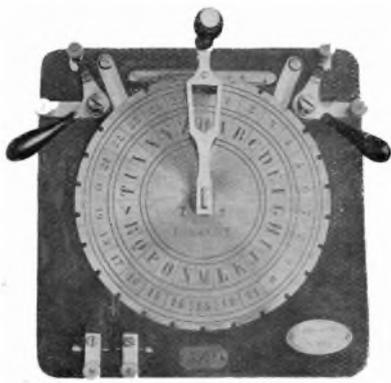
Manipulateur d'un télégraphe à cadran Bréguet
