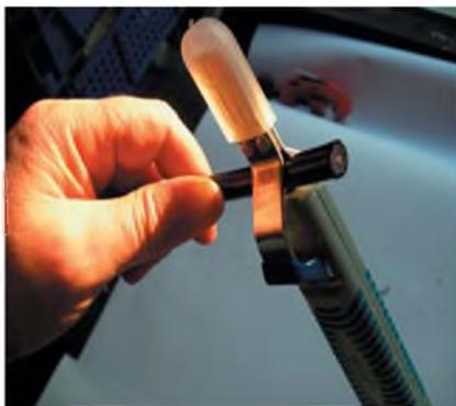
photo 2 : dénuder au moyen d'un couteau à dénuder
