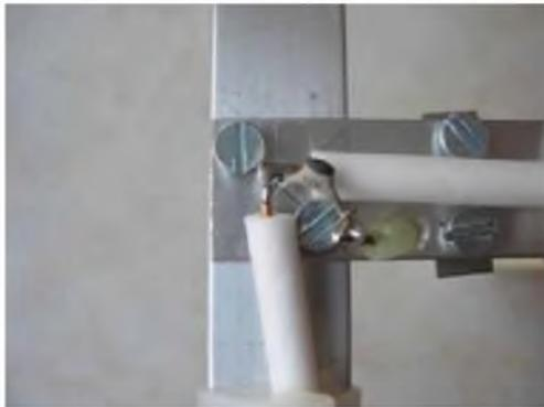
Le câble coaxial de sortie de l'antenne s'attache au niveau de la tresse de masse sous le cavalier. L'âme traverse du côté de la ligne par un trou. Terminer en soudant un condensateur céramique de 12 entre l'âme du coaxial et le coude de la ligne. L'étanchéité de cette jonction s'applique avec de la colle thermo fusible (pistolet à colle)
