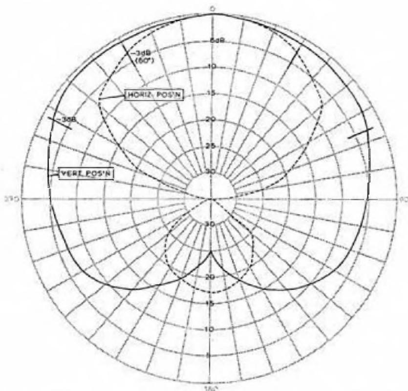
En position horizontale, l'antenne présente un rapport avant / arrière et un creux très prononcé perpendiculairement à la direction principale (diagramme en pointillé).
