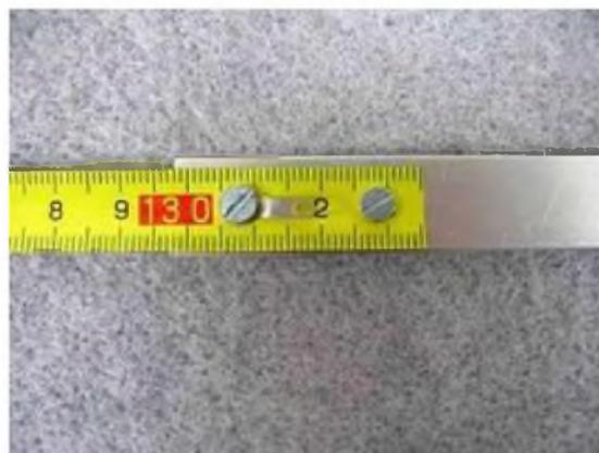
Les extrémités sont arrondies avec les ciseaux à tôle. Puis, le tranchant émoussé à la lime fine. Pour plus de sécurité, recouvrir les extrémités de gaine thermo-rétractable, ou d'un adhésif tissé (type Tésa), en faisant dépasser d'un demi-centimètre.
