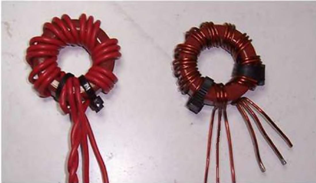
Donc, un balun est un transformateur. Comme tout transformateur digne de ce nom il comporte un enroulement au primaire et un au secondaire.
