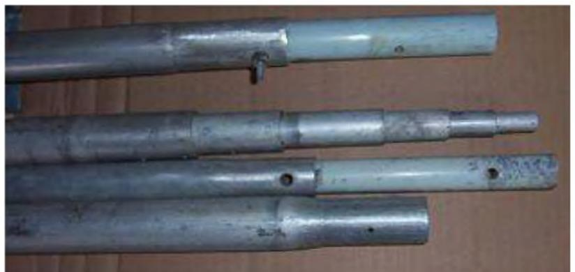
Le montage fait appel à des rivets alu (que l'on trouve maintenant couramment en GdS) selon l'adage de la fabrique « if riveted it's Force 12 » et l'érection de l'ensemble est aisée, même pour un seul OM.
