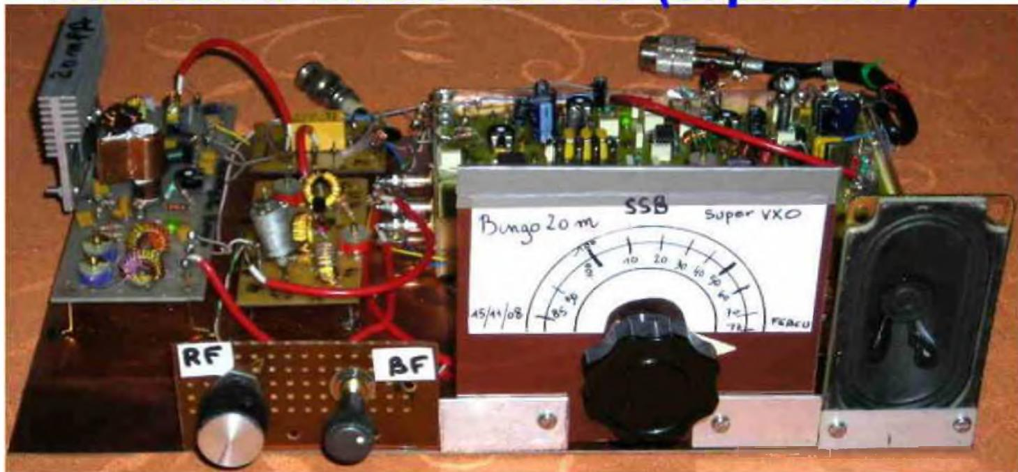
Cet article est la suite du BINGO SSB 20 m avec P.T.O, où nous avons remplacé le P.TO par le Super V.X.O.
