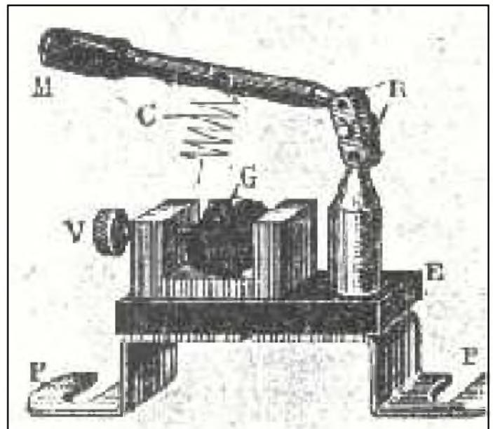
Les 3 figures page suivante représentent les principaux schémas utilisés pour la fabrication des postes à galène. Il est à noter que le détecteur à été remplacé par un diode au germanium qui présente un seuil d'environ 0,25V (silicium environ 0,7V).
