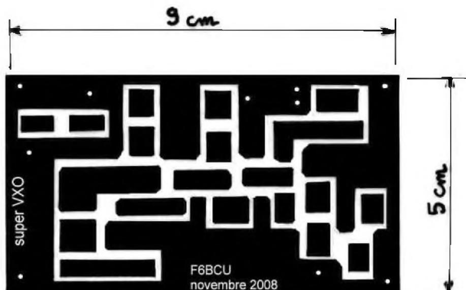
Les Composants qui garnissent le circuit imprimé sont directement câblés côté cuivre. On s'accommode soit des composants traditionnels, de CMS, ou un ensemble mixte. Les fils d'alimentation passent sous le circuit à travers des trous pré-perçés. Il est vivement conseillé d'étamer copieusement les pistes avant d'y souder les premiers composants.
