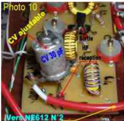
Bien vérifier si vous n'avez pas trop de gain HF en réception (souffle important en branchant l'antenne). S'il est nécessaire de le réduire, insérer un petit condensateur ajustable comme sur la photo N°10 cet ajustable à une valeur de 30 pF et est très peu engagé, il est en série entre la sortie de l'amplificateur HF réception et le câble coaxial. Ultérieurement, vous pouvez le remplacer par une capacité fixe qui peut aller de 2,2 pF à 47pF et plus.
