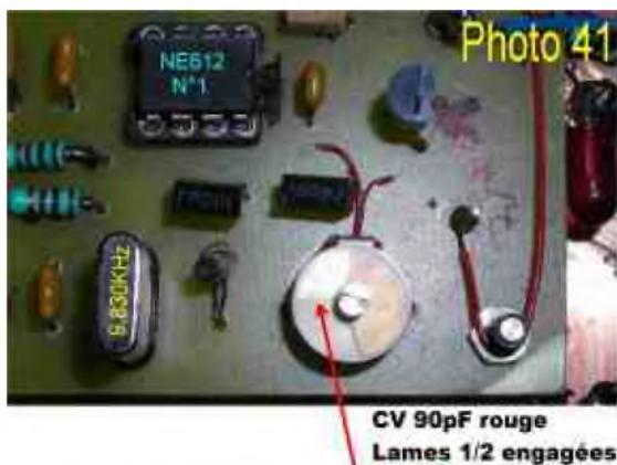
Ce Générateur BINGO CW fonctionne avec un filtre à quartz 9.830 KHz. A titre indicatif, sur la photographie 41 à gauche, voici la position de l'engagement des lames du CV ajustable de 90 pF rouge de notre transceiver BINGO CW 17m qui sont environ à 1 / 2.
