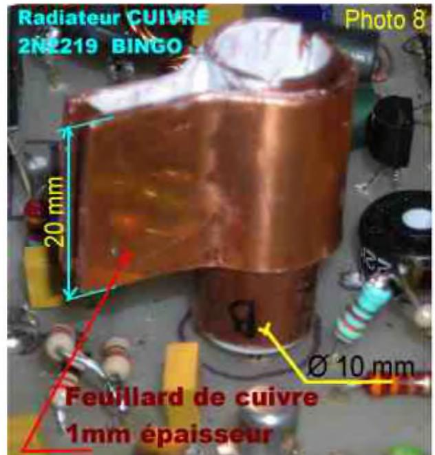
L'utilisation de tube de cuivre rouge de chauffage de  $\varnothing$  10mm extérieur et de  $\varnothing$  8mm intérieur est parfait pour refroidir un transistor 2N2219 dont le chapeau métal extérieur fait un  $\varnothing$  de 8,2mm. Un double trait de scie à métaux sur le tube de 25 mm de long, tube emmanché à force sur le 2N2219 et un morceau de feuillard de cuivre rapporté et cintré sur le tube de cuivre ( photo 7 et 8 ) forment un excellent radiateur à forte dissipation thermique.
