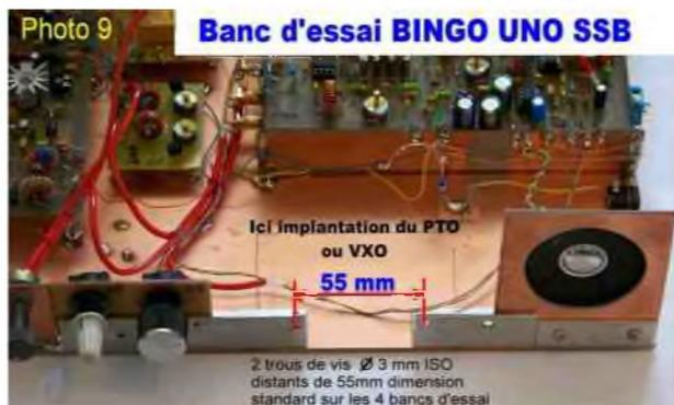
(Photo 9) : Détail de la fixation du PTO interchangeable. Emplacement prédéterminé, Entre-axe standard des trous de 3 mm de fixation des PTO sur les 4 bancs d'essais.
