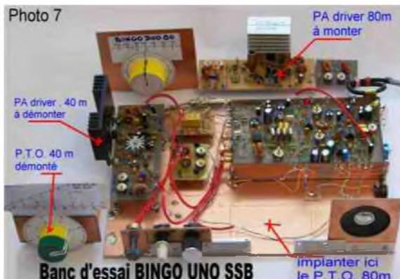
(Photo 7) : Voici les véritables opérations d'interchangeabilité des composants, avec le PTO 40m à gauche démonté et le PTO 80 à remonter à l'emplacement libre ; comme le Driver PA 80m en remplacement du Driver PA 40 m à démonter.
