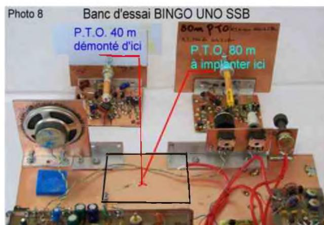
(Photo 8) : Opération de remplacement du PTO. Le PTO 40 m est démonté, le nouveau PTO 80 m va le remplacer. Les fixations sont prévues par vis et écrous et les trous pré-perçés standardisés. L'interchangeabilité est totale de 160 à 10 m.
