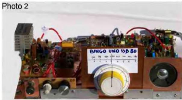
(Photo 2) : Le transceiver BINGO UNO SSB 80 m de juin 2009, est la nouvelle génération de BINGO bande 80 m. Le PA utilise 1x IRF510 en remplacement de l'ancien IR F 530 et côté réception un double filtre de bande accordé, bien plus efficace que l'ensemble précédant à valeurs fixes. Le PTO remplace le VFO d'origine. La puissance de sortie est proche de 10 watts HF sous 13.8 V. Ce BINGO UNO 80 SSB est assemblé sur le banc d'essai de BINGO 40 SSB.
