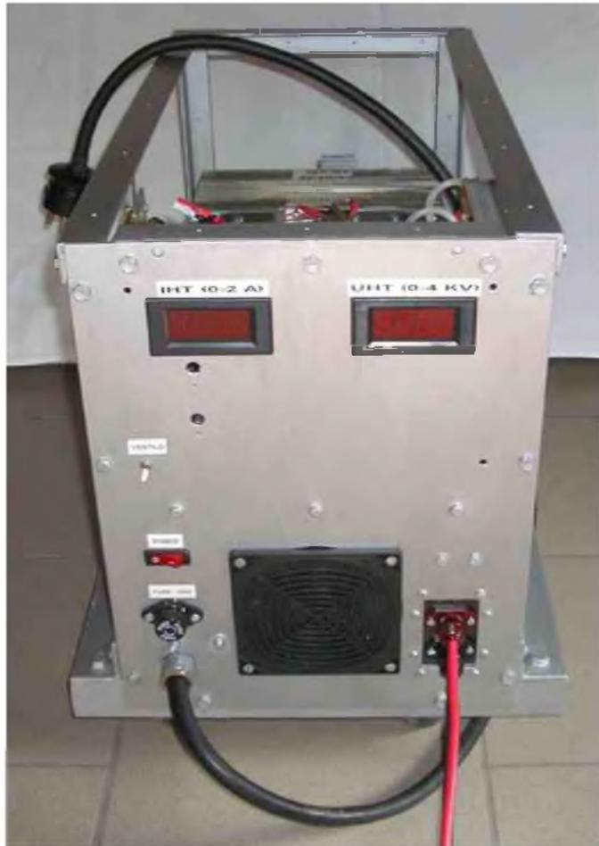
*Photo n° 3 : l'alimentation du filament et des grilles G1 et G2.*
