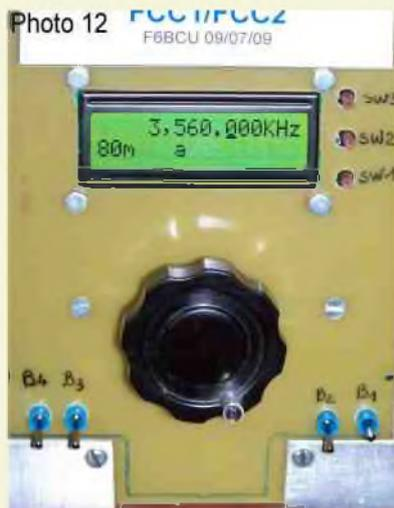
Version multi-bande du DDS équipé des interrupteur B1 à B4
