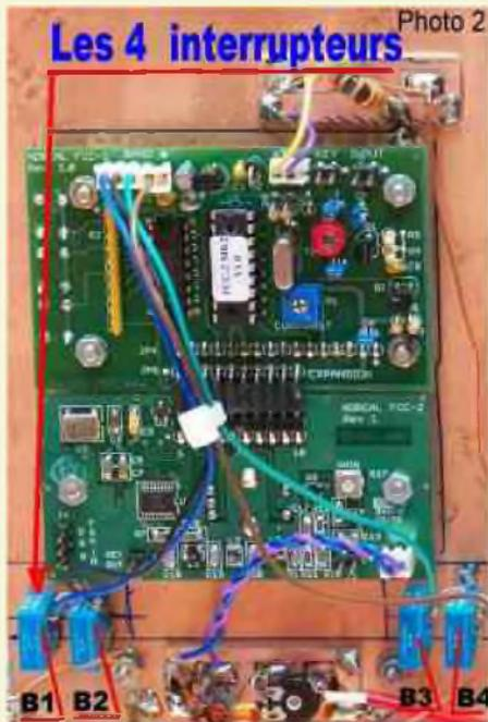
Les interrupteurs : B1, B2, B3, B4, (ON, OFF) assurent la programmation en système binaire de l'appel des mémoires suivant les combinaisons indiquées sur le tableau N°9 ci-dessous, pour les bandes de 160 à 2 m. Sur le FCC2 le choix de bandes s'arrête à 2 mètres. Sur le FCC1 on va jusqu'à 70cm. Les fonctions inutilisées par le FCC2 sont remplacées par Dir ou Direct.
