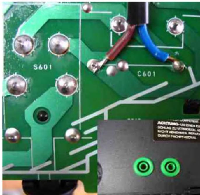
Dans certains cas, pour que le câble ne passe pas sous le châssis, il est parfois plus aisé de souder ce dernier du côté des composants ou par des trous aménagés dans le circuit imprimé.
