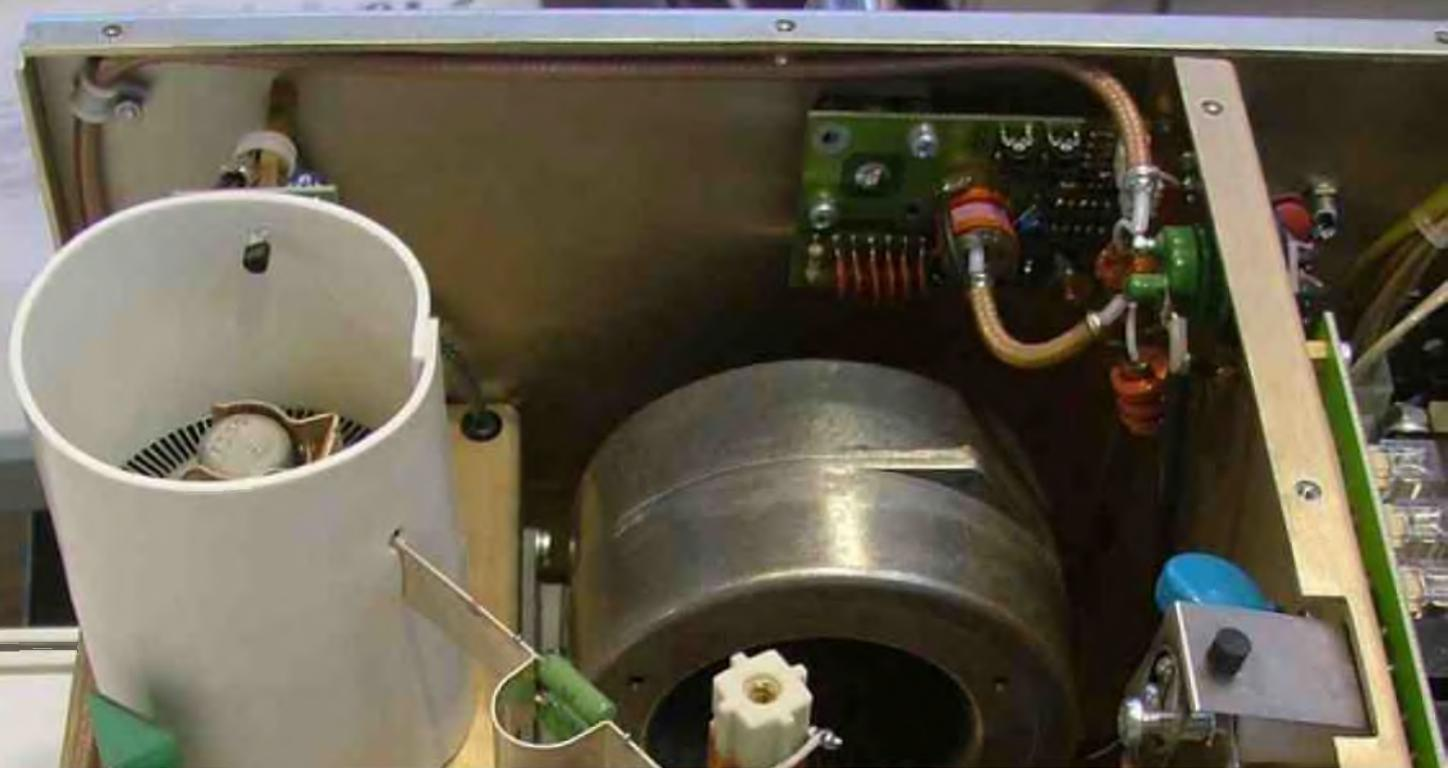
Etude et construction d'un appareil destiné au test, reconditionnement (régénération) et à l'appareusement (« matched pair of tubes ») des tubes électroniques de puissance (GU74B-4CX800A).
