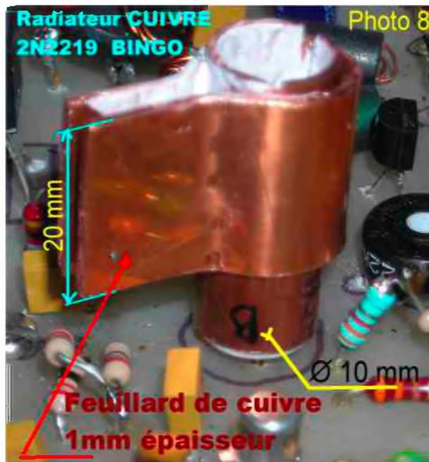
L'utilisation de tube de cuivre rouge de chauffage de Ø 10mm extérieur et de Ø 8mm intérieur est parfait pour refroidir un transistor 2N2219 dont le chapeau métal extérieur fait un Ø de 8,2mm. Un double trait de scie à métaux sur le tube de 25 mm de long, tube emmanché à force sur le 2N2219 et un morceau de feuillard de cuivre rapporté et cintré sur le tube de cuivre ( photo 7 et 8 ) forment un excellent radiateur à forte dissipation thermique.
