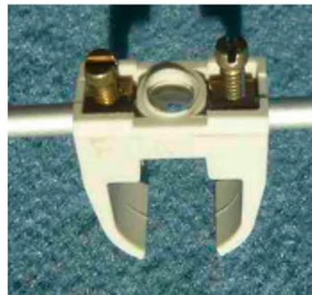
Enfin, il est préférable de limer le bout des tiges de l'élément rayonnant, et de réduire la longueur des vis de fixation.
