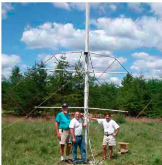
**Antenne NVIS radioamateur**
