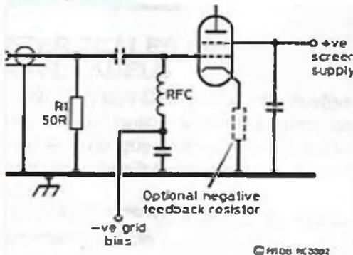
Pour une tétrade polarisée en classe AB2 (un peu de courant grille) le circuit est bien connu et nécessite simplement une résistance de charge pour absorber un peu de la puissance appliquée lorsque le tube n'amplifie pas et procure la stabilité de charge nécessaire au bon fonctionnement de l'émetteur et de plus, charge correctement le tube pour empêcher toute auto oscillation.
