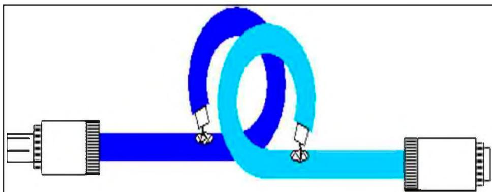
Assembler les boucles, comme montré par la figure, de façon à éviter que les parties dénudées soient en regard l'une de l'autre.
