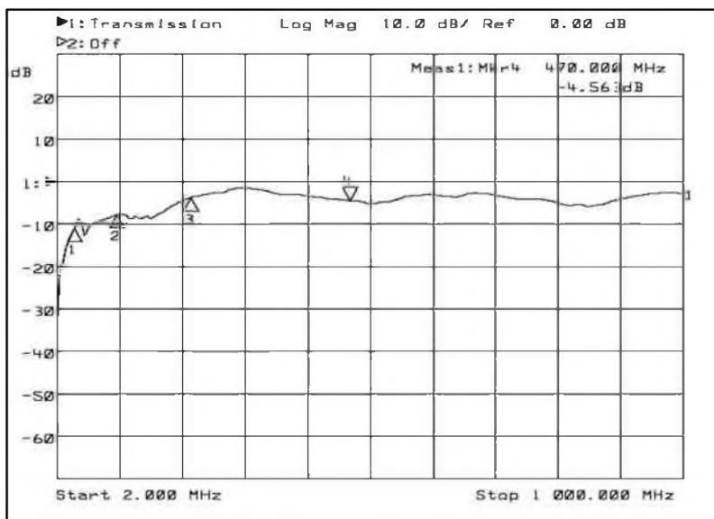
La courbe ci-contre monte la fonction de transfert du dispositif de 2 MHz à 1 GHz. Le marqueur 1 est à 30 MHz, le marqueur 2 à 98 MHz (bande FM), le marqueur 3 à 216 MHz (bande TV VHF) et le marqueur 4 est le début de la bande UHF de 470 à 860 MHz. L'ondulation de la courbe peut varier suivant le couplage et la nature des câbles employés. En pratique, le feuillard qui recouvre la boucle, améliore la réponse en UHF.
