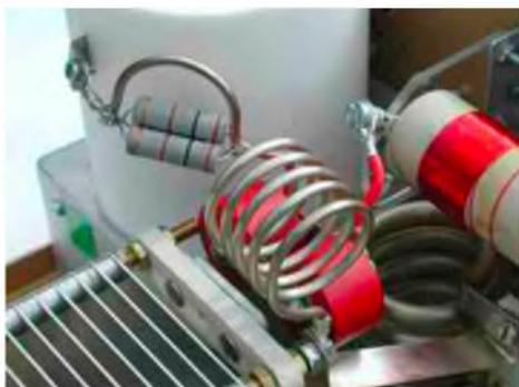
La self pour l'accord du 29MHz n'est pas incluse dans la self à roulette d'origine mais fait l'objet d'un bobinage séparé (on aurait pu penser au 50MHz Hi !) pouvant du reste accepter plus de courant.
