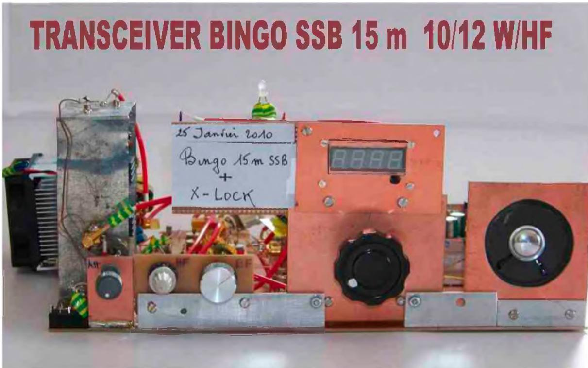
**Prototype de la version TURBO du BINGO SSB 15m avec un push-pull de RD16HHF1 mosfets**
