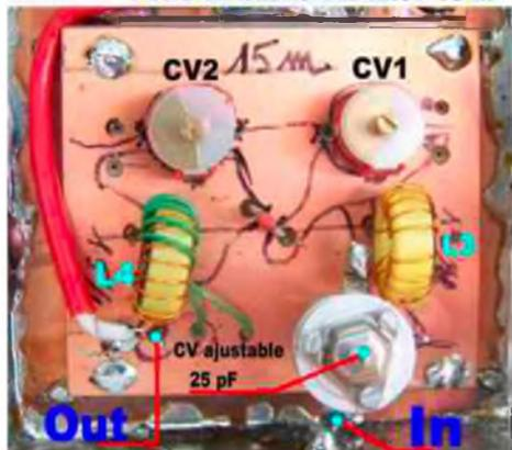
Le filtre de bande émission n'est plus intégré à l'étage Driver, il préserve son utilisation commutable pour une future utilisation en multi-bandes, commutation par diodes. Pour s'adapter au mieux au mélangeur NE612 son entrée est en haute impédance. La sortie reste classique en basse impédance 50 ohms.
