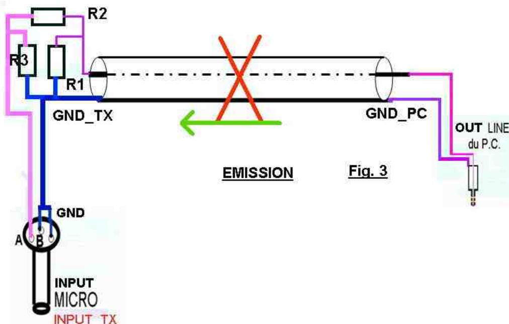
La solution est d'adapter le niveau des signaux: Pour cela, il suffit de placer un atténuateur à l'entrée de l'émetteur.
