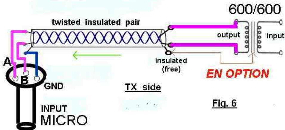
Le câble blindé torsadé a remplacé le fil simple blindé.
