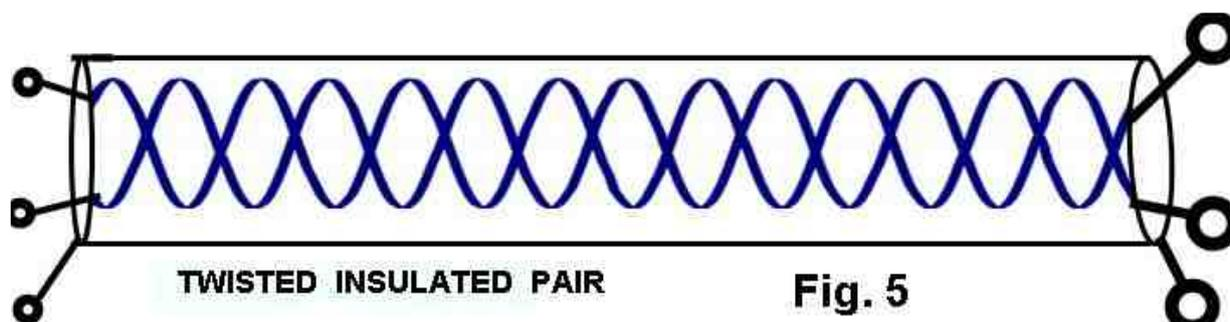
La liaison est bifilaire blindée et on doit s'assurer que les deux fils sont effectivement torsadés, la torsade étant fort serrée, la tresse isolée !
