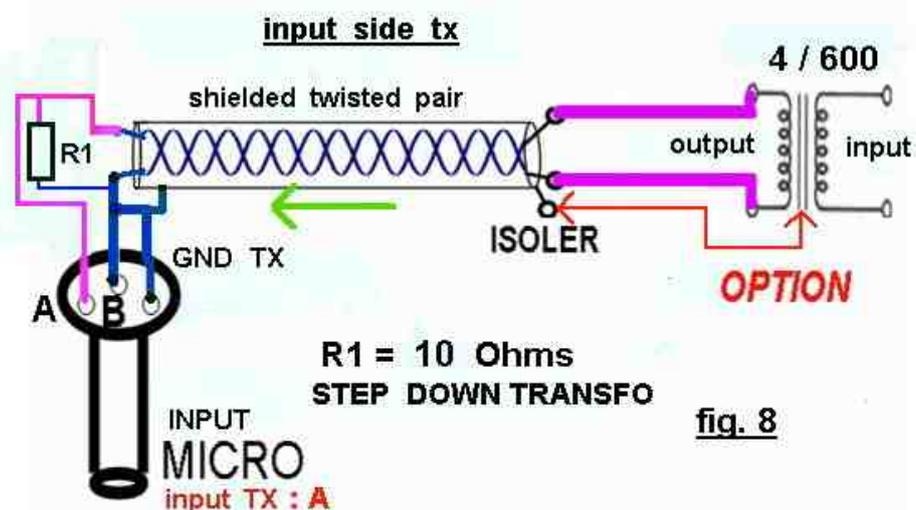
Le câblage est naturellement plus facile à réaliser ! Il ne reste qu'une seule résistance à souder sur la prise micro !
