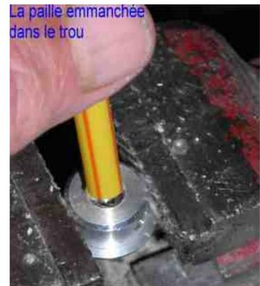
Le manchon en aluminium est percé au diamètre de 7 mm sur une profondeur de 2 mm la paille est ensuite enfoncée dans le trou en forçant légèrement. Quelques gouttes de colle Glue 3 ou Cyanolite suffisent pour une immobilisation solide et durable.
