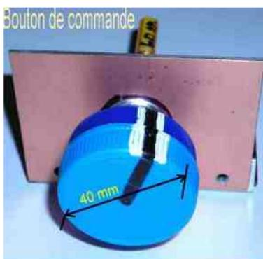
La fixation du P.T.O. BINGO sur le panneau avant ou la façade nécessite de faire un trou de diamètre 16 mm et d'ajuster pour que le manchon pénètre librement dans le trou. L'immobilisation du manchon se fait par quelques gouttes de cyanolite sur l'épaulement. Presser fort quelques instants et la solidité est remarquable.
