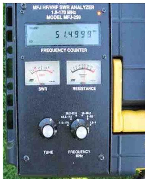
Finalement à la fréquence de résonance autour de 50.125 MHz on obtient ceci : 1/1 avec 50 ohms. Une pure merveille. Aucuns problèmes pour s'amuser sur au moins un mégahertz. Il faut dire qu'ici en Amérique, nous bénéficions de 4 mégahertz (50-54 MHz) de façon exclusive. La partie de 52 à 54 MHz est utilisé par les Relais, surtout Américains. Il y en a très peu ici au Canada. Même en SSB/CW cette bande est vraiment sous-utilisée. Ce qui est à mon avis terrible.
