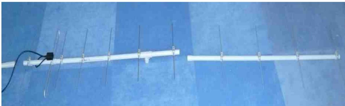
J'ai prévu une poignée à l'arrière de l'antenne dans le cas d'utilisation de la version 7 éléments, et un T clipsé entre le 1er et le 2ème directeur de la 7 éléments pour y mettre un tube servant de mat dans le cas d'utilisation des 11 éléments
