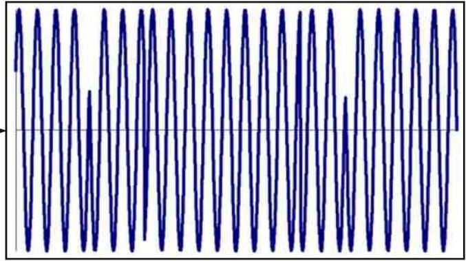
Les points d'inversion de phase sont repérés par les fleches. Il est évident que injecter un tel signal dans un émetteur va générer des fronts raides donc énormément de clicks !!
