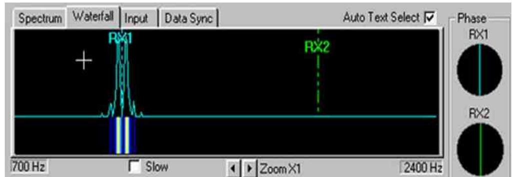
**Spectre relevé dans la bande 14.070 KHz (plusieurs émetteurs !!)**
