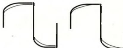
L'exemple ci-dessus illustre ce phénomène. En trait fin, a été représentée la trace de la courbe précédente. Dans le premier cas nous voyons que l'amplitude du signal carré a augmenté. La fréquence du signal de compensation est trop élevée. Le réglage risque d'être imparfait. La plage où les paliers à l'écran semblent horizontaux est trop importante.
