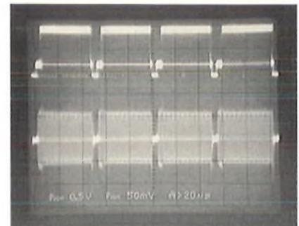
Sur TV, choisir plutôt la mire OIRT et régler L1 pour que le pavé rouge sur fond jaune en bas de mire soit le plus uniforme possible (réglage visible aussi sur le pavé bleu et rouge supérieur).
