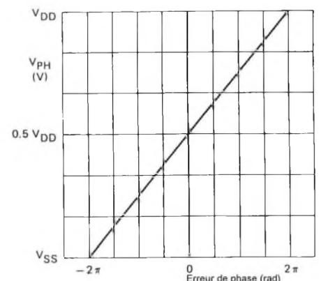
La tension analogique de phase sur PH est utilisée pour corriger la fréquence sur OSCI via un oscillateur commandé en tension et annuler l'erreur de phase entre les signaux interne et externe. Les impulsions qui apparaissent sur ESC en dehors des
