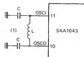
La valeur des composants peut être calculée par la formule  $F_{osci} = 1/2\pi\sqrt{LCv}$  avec  $Cv = C/2 + Cp$  et  $Cp =$  capacité parasite (typ = 5 pF).
