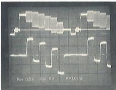
Pour un réglage sur visualisation TV, soit régler ces deux composants pour obtenir des positions mécaniques proches de celles indiquées, soit les ajuster pour obtenir un effet le lignage chromatique (effet de persienne, dans le jargon des techniciens TV) minimum. Cet effet est surtout perceptible dans les pavés de teintes magenta et cyan.
