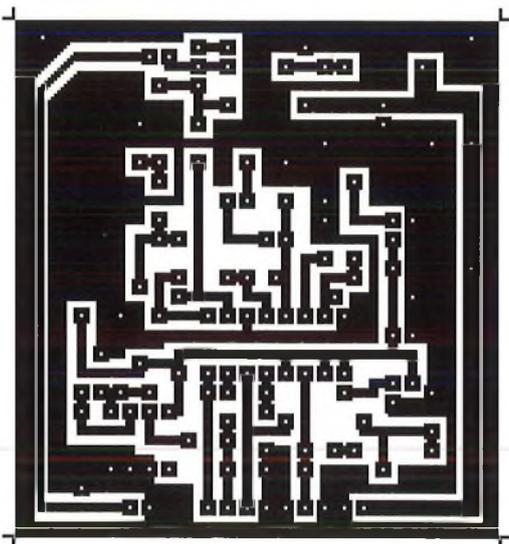
Décodeur Pal-Secam NTSC: Platine de synchronisation Réf. 4603
