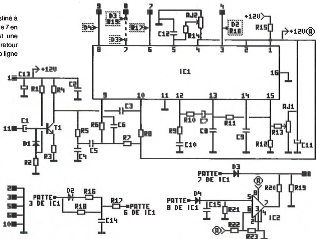
Allongé dans le temps par une procédure de même type que pour la ligne, cette fois par D4, C15 et R21, ce top allongé est appliqué à une porte d'AOP IC2 montée en comparateur. L'entrée moins y reçoit un potentiel constant de 6 volts défini par R22 et R23.
