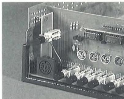
Naturellement d'autres personnes préféreront placer cet inverseur sur l'arrière du coffret. C'est un choix qui est fonction de l'utilisation. Dans le cas d'utilisation d'un inverseur classique (pas de réalisation du circuit imprimé fourni), il faudra songer à ramener le fil de masse qui pourra être pris directement au niveau du point de validation.
