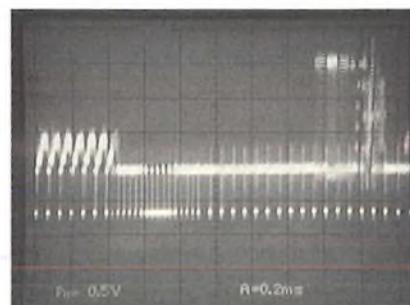
L'oscillogramme ci-dessus montre un tel top trame normalisé et le dessin ci-dessous la façon réelle sous laquelle il se présente.
