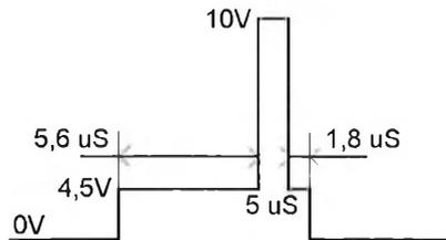
Injecter ensuite dans X2 un signal vidéo composite normalisé (1 volt, positif), codé SECAM. Dès cet instant, et en moins de 500 mS, la LED de standard SECAM (D7) doit s'allumer fixe. Connecter ensuite le téléviseur en sortie: la consommation doit passer à 250 mA et une image, dans l'immédiat peu importe son aspect, doit apparaître.
