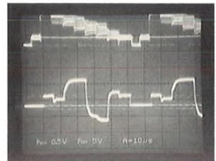
Régler L3 pour amener les paliers correspondants à la barre blanche et la barre noire en alignement avec le palier d'effacement. Le bon réglage doit donner l'oscillogramme suivant:
