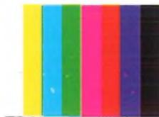
La mire PG104 est le compromis idéal pour faire de la maintenance sur les appareils vidéo. Elle délivre les signaux sous forme RVB, SVHS (Y-C), vidéo composite PAL ou SECAM, et UHF (2 canaux simultanés). Ses huit mires de base permettent de localiser tous les problèmes en TV, Vidéo, scopes, etc... Elle permet en plus le test des appareils 16/9. Incrustation de texte en option (voir dans ce numéro).
