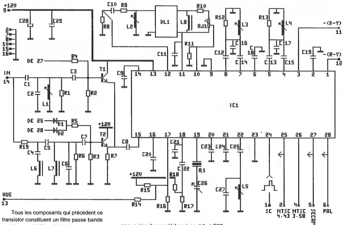
Tous les composants qui précèdent ce transistor constituent un filtre passe bande centré sur 4,43 MHz qui isole la composante chrominance de Y en respectant le plus fidèlement possible la phase de ce signal.
