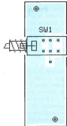
Cette prise sera fixée sur l'arrière du coffret. Seuls trois points seront utilisés. Il s'agit de la masse, du signal RX et du signal TX. La liaison s'effectuera au moyen d'un morceau de câble blindé à deux conducteurs qui sera soudé sur un connecteur coudé.
