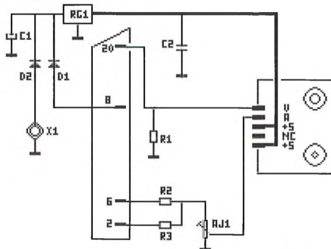
L'alimentation enfin est soit réalisée par l'extérieur, par X1, ou prélevée sur la commutation lente lorsque cela est possible pour certains appareils (voir annexe ci-dessous à ce sujet).
