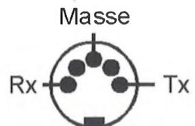
Le câblage de la prise DIN châssis est donnée ci-dessus. Elle est vue coté soudure.
