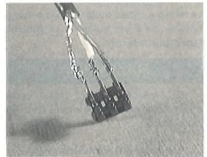
Les points de liaisons 1(masse) 2 (Tx) et 3 (Rx) seront soudés conformément à ce qui est donné sur le schéma.
