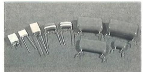
La fabrication de ces condensateurs est identique à celle des condensateurs papier. La feuille de papier est remplacée par une feuille de plastique.
