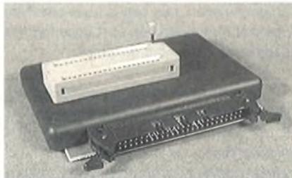
Une entaille de la largeur du circuit imprimé sera faite dans la partie inférieure du coffret pour pouvoir laisser passer intégralement l'ensemble du connecteur d'extension.
