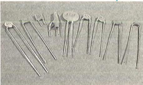
Les céramiques utilisées dans les condensateurs sont des mélanges complexes de silicate de magnésium (talc), d'alumine, de Corydon, de zircon, de feldspath auxquels on ajoute en fonction du diélectrique désiré du titane, du baryum, du calcium, du magnésium, etc...
