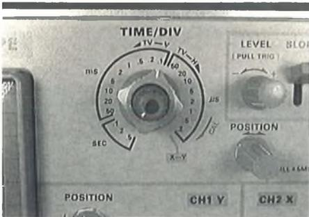
On remarquera, au vu de ce commutateur, que le dénuement de la façade s'explique en partie par ce commutateur. En effet, il existe souvent un inverseur permettant de choisir entre la synchronisation trame ou ligne en mode TV, qui est ici réalisée automatiquement par le passage du calibre 0,1 mS à 50 uS de la base de temps.
