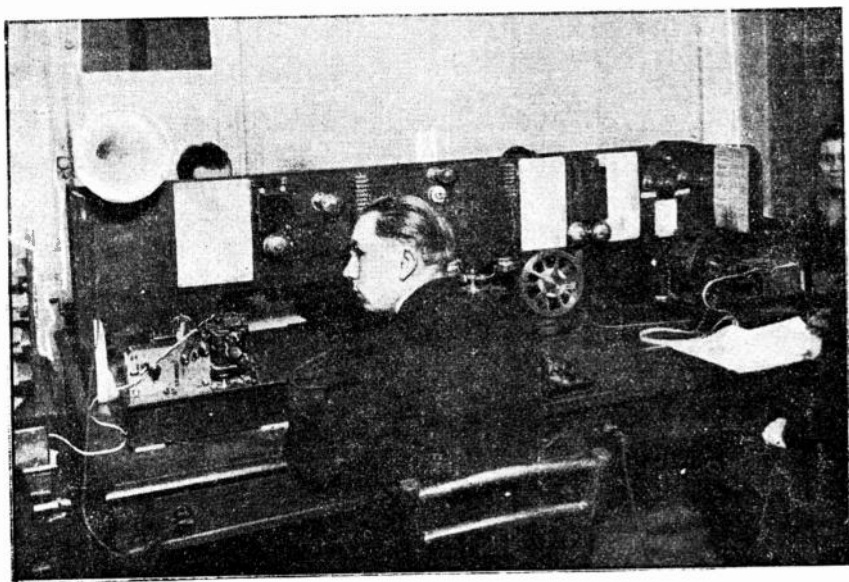
Fig. 6. — Manipulation et réception automatiques à gauche, réception enregistrée sur bandes de papier; à droite, manipulation automatique et à la main)
