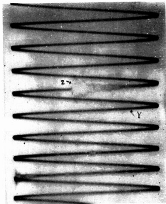
Fig. 48. — Oscillations amorties : Courbe de tension. Fréquence : 70 000 000 \lambda = 4 m 3
