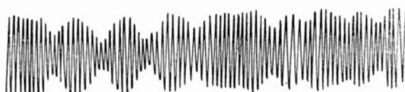
G: Onde modulée seulement sur les positifs du courant microphonique
