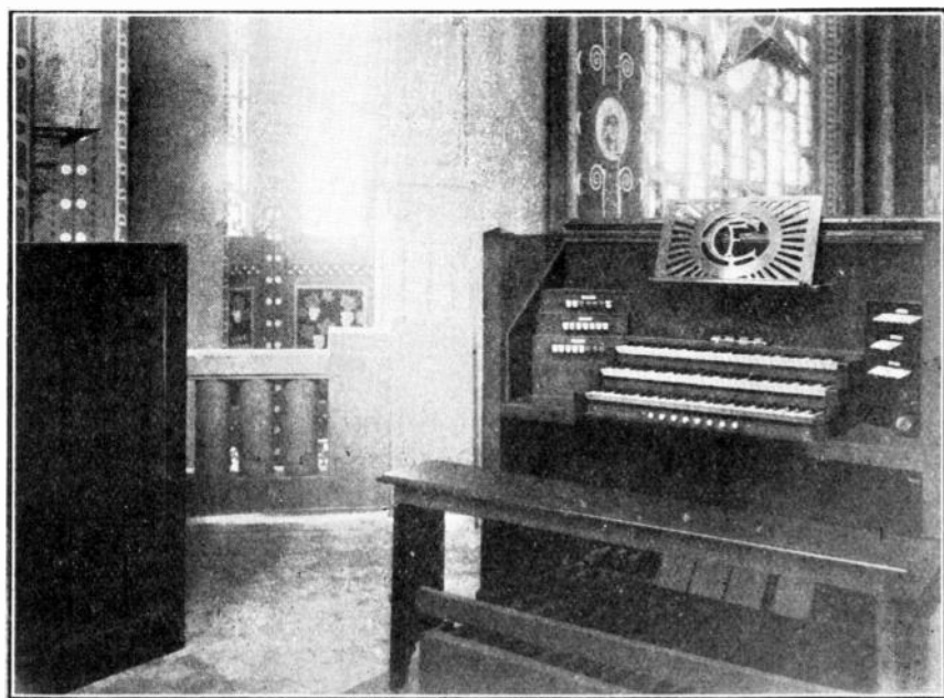
Fig. 3 — L'orgue électronique d'Henin-Liétard. Vue de la console avec les claviers et les commandes des divers jeux. A gauche, extrémité de l'armoire à lampes.
