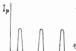
Fig. 3. — Diagramme oscillographique du courant de plaque dans l'oscillateur des figures 1 et 2.
