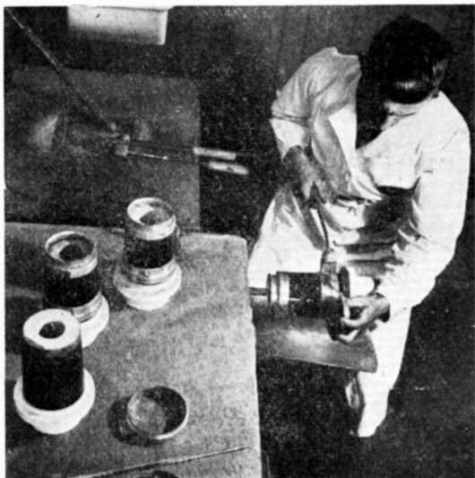
Fig. 15. — Soudure de collerettes sur porcelaine.
