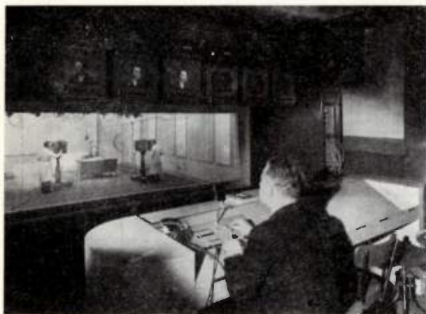
FIG. 2. — De la régie : Vue du studio. Dans la régie : pupitre de commande et meuble mélangeur.
