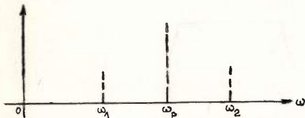
FIG. 1. — Spectre de raie d'une porteuse \omega_p modulée par une fonction sinusoïdale.
