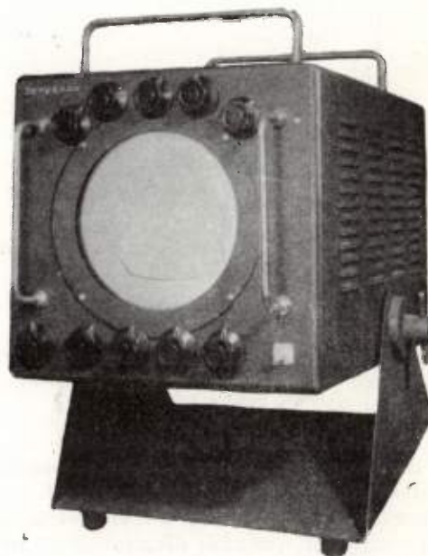
Récepteur d'image spirale à écran plat, rond et aluminé en modèle de table à inclinaison réglable. Les commandes de la caméra se font à partir du récepteur.
