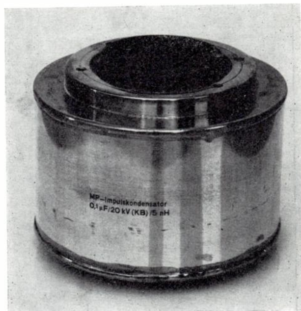
Condensateur 0,1 \mu F ; 20 kV à faible inductance.
