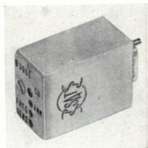
FIG. 4. — Oscillateur de sous-porteuse B 9300 et traducteur de tension D 3900.
