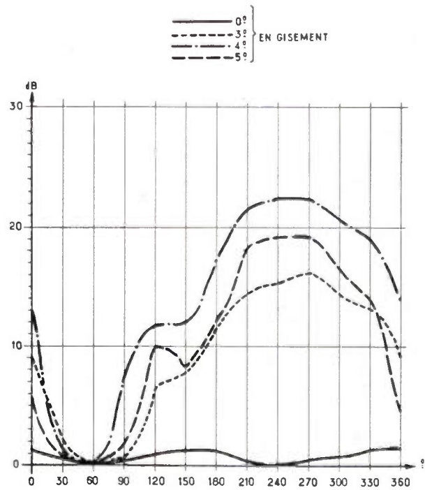
FIG. 5. — Modulation obtenue pour diverses valeurs du dépointage \theta .
