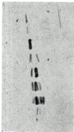
FIG. 8. — Gerbe développée dans la chambre par un électron cosmique de grande énergie.
