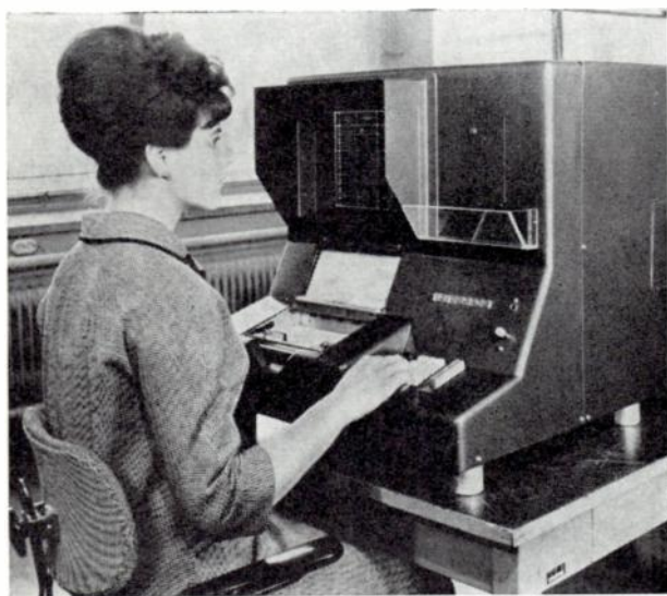
FIG. 2. — Un classeur électro-optique. Pour rationaliser les tâches de documentation. Le classeur "Elo" est un registre de diapositifs avec appareil viseur et diapositif chercheur automatique incorporés. Pour des fins spéciales, par exemple pour la comparaison de signatures dans les banques et bureaux de chèques postaux, l'appareil est pourvu d'un dispositif à signer avec dispositif automatique pour l'introduction des documents.
