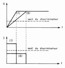
Fig. 1. — Impulsions de courant et de charge délivrées par une diode Ge(Li) plane.
