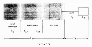
Fig. 2. - Température de bruit du système
