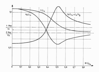
Fig. 14. — Courbes théoriques de dispersion pour  $\sigma=0,29$  dans un fil
