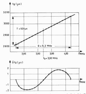
Fig. 10. — Résultats expérimentaux des mesures de linéarité effectuées sur la ligne dispersive « ruban » de la figure 9.
