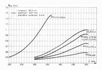
obtenues avec un tube, plongé dans l'eau, de 68 cm de longueur, de 2 mm de diamètre et de 0,07 mm d'épaisseur lorsqu'il contient divers liquides.
