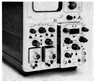
« Tektronix ». Tiroirs échantillonneurs 3 S2 et base de temps aléatoire 3 T2
