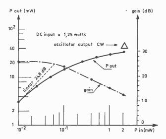
Fig. 2. — Performance de l'amplificateur de puissance à diodes à avalanche aux fréquences dans les bandes X.
