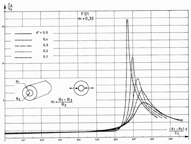
Fig. 44. — Courbes de variation du temps de retard en fonction du coefficient de Poisson pour m = 0.33.
