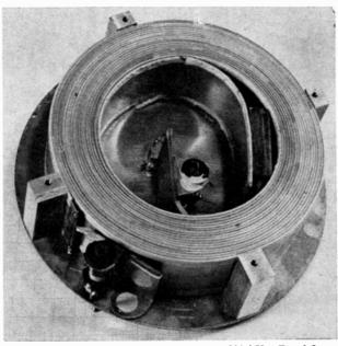
Fig. 9. — Ligne dispersive « ruban » : B = 200 kHz, T = 0.5 ms.
