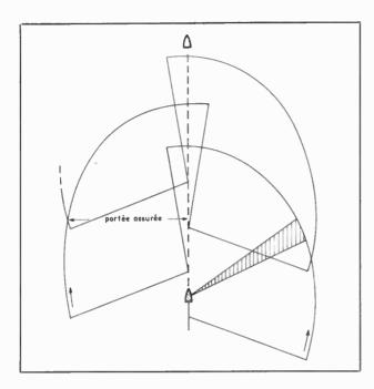
Fig. 1. — Méthode d'exploration par sonar directif. Portée 3 000 m. Vitesse 20 nœuds.
