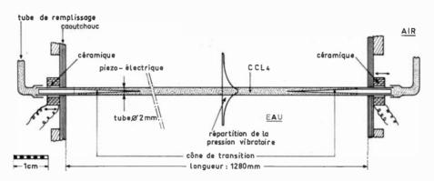
Fig. 34. — Guide stratifié liquide pour la propagation d'ondes de surface dispersives.
