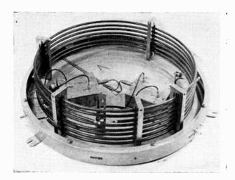
Fig. 46. — Ligne dispersive métallique tubulaire : B = 5 MHz, T = 10 ms.
