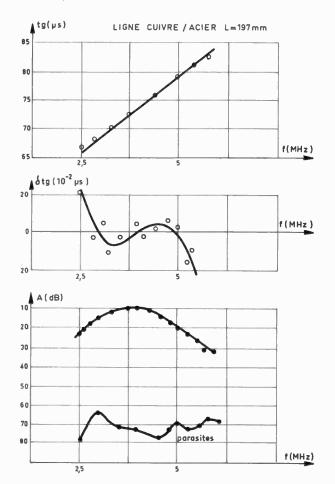
Fig. 30. — Résultats expérimentaux des mesures effectuées sur la ligne en ondes de Love de la figure 29.
