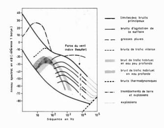
Fig. 6. - Niveau spectral du bruit.
