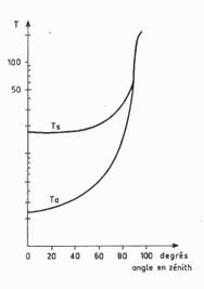
Fig. 4. — Température du système en fonction de l'angle au zénith (5 650 MHz).
