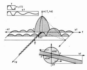
Fig. 4. — Fonction d'ambiguîté d'une impulsion rectangulaire modulée linéairement en fréquence : étalement des lobes latéraux en distance.
