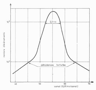
Fig. 4. — Courbe de coïncidences promptes (déclenchement par l'impulsion de courant).
