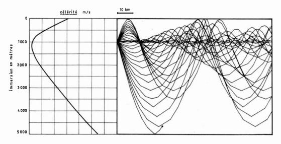
Fig. 4. — Tracés de rayons sonores : source à 1 000 m.
