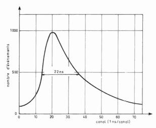
Fig. 9. — Courbe de coıncidences promptes donnée par le montage de la figure 8. Source : °°Co. Le sélecteur d'amplitude de la voie latérale du détecteur D<sub>1</sub> est réglé de manière à ne conserver que les impulsions correspondant au pic photoélectrique de 1,33 MeV; le détecteur D<sub>2</sub> ne comporte pas de voie latérale de sélection d'énergie.
