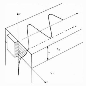
Fig. 27. — Guide stratifié solide pour la propagation des ondes de Love.
