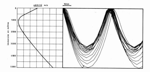
Fig. 3. — Tracé de rayons sonores : source à 100 m.
