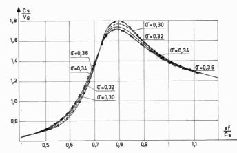
Fig. 8. — Dispersion du 1er mode d'extension Eo1 dans un ruban.
