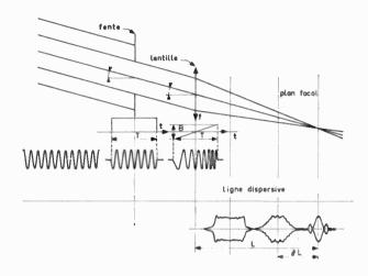
Fig. 3. — Analogie optique de la compression d'impulsion.
