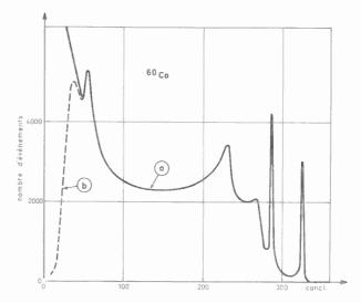
Fig. 7. — a) Spectre normal de 60Co.
