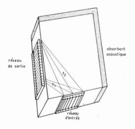
Fig. 25. — Montage dispersif à diffraction perpendiculaire de Duncan et Parker.
