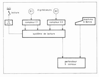
Fig. 6. - Schéma bloc du système de mesure
