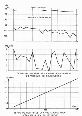
Fig. 33. — Résultats expérimentaux des mesures effectuées sur la ligne de la figure 32.
