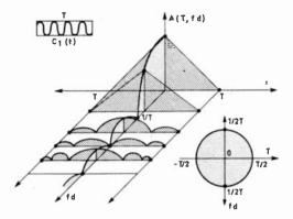
Fig. 3. — Fonction d'ambiguïté d'une impulsion rectangulaire.
