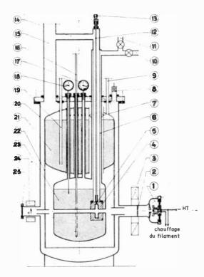
Fig. 5. — Cryostat 1967. Description générale. NB: tous les éléments en particulier la came de transfert, ne sont pas situés sur un même plan.
