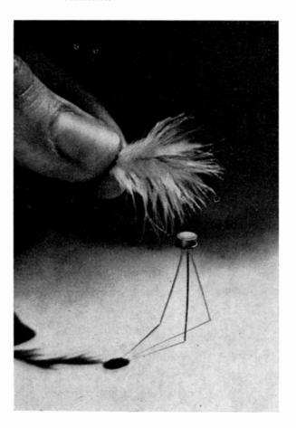
En raison notamment de son faible encombrement, ce composant semble devoir trouver de nombreuses applications industrielles, en particulier dans les dispositifs de mesure de pression différentielle, les accéléromètres, les mesureurs de flux, les jauges de niveau, les appareils de pesée et les microphones très sensibles.
