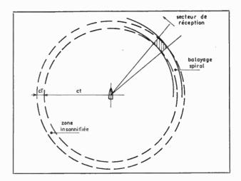
Fig. 2. — Sonar panoramique à balayage spiral
