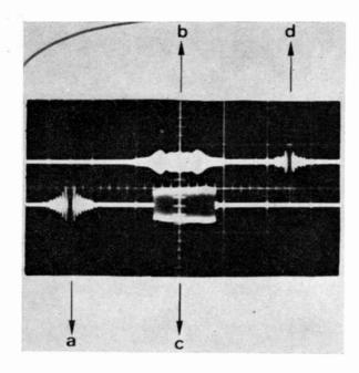
Fig. 21. — Ligne « ruban » à modulation d'épaisseur, de taux de compression K = 20.
