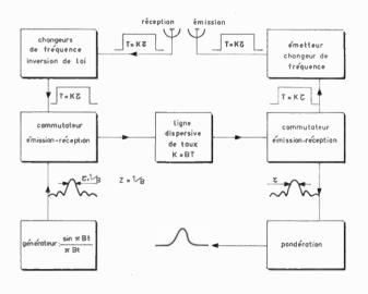
Fig. 2. — Schéma synoptique d'un radar à compression d'impulsion.
