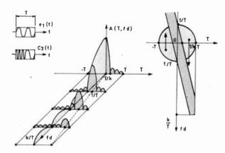
Fig. 5. — Fonction d'ambiguïté d'une impulsion rectangulaire modulée linéairement en fréquence : étalement des lobes latéraux en fréquence.
