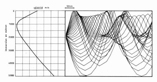
Fig. 5. — Tracés de rayons sonores : source à 2 000 m.
