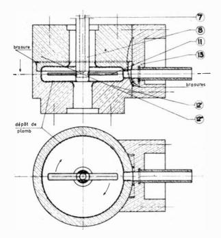
Fig. 4. — Cavité TM<sub>010</sub> dépôt électrolytique avec une anode tournante.
