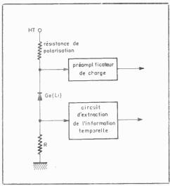
Fig. 2. — Utilisation des deux sorties isolées d'un détecteur Ge(Li).
