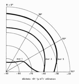
Fig. 7. — Distribution du bruit à 750 Hz.
