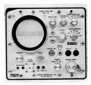
« Cossor-Instruments ». L'appareil CME 10 permet de localiser. rapidement les défauts des câbles
