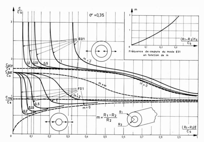
Fig. 41. — Courbes de dispersion des modes  $F_{01}$  et  $E_{01}$  pour diverses valeurs de m et pour  $\sigma = 0.35$ .
