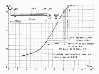
Fig. 39 : Résultats expérimentaux avec une ligne à gaz : air et  $SF_{\bullet}$ .  $SF_{\bullet}$  : épaisseur : 2 mm, largeur : 6 cm, épaisseur de la membrane de mylar : 6  $\mu$ s, longueur de la ligne : 3 mm.
