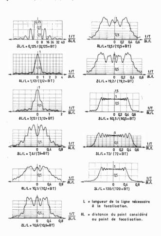
Fig. 4. — Courbes d'amplitude théoriques des signaux intermédiaires.
