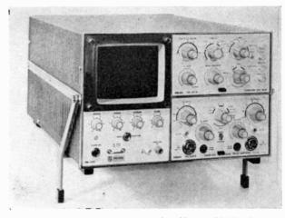
« Philips ». Oscilloscope à échantillonage PM 3 410
