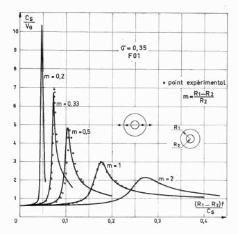
Fig. 45. — Courbe de variation du temps de retard de groupe du mode  $F_{01}$  pour diverses valeurs de m et pour  $\sigma = 0.35$ .
