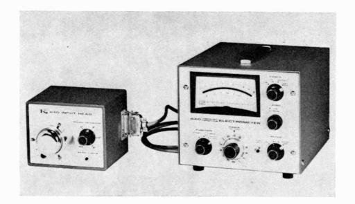
« Keithley ». Électromètre à condensateur vibrant type 640.
