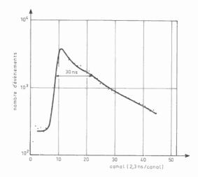
FIG. 6. — Courbe de coïncidences promptes (déclenchement par l'impulsion de charge).
