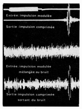
Fig. 40. — Résultats expérimentaux de l'expérience de compression d'impulsion relative à la courbe de la figure 39.
