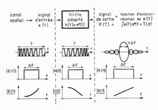
Fig. 1. - Modulation linéaire de fréquence
