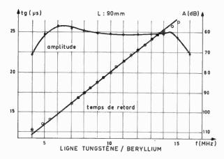
Fig. 31. — Résultats expérimentaux des mesures effectuées sur la ligne en ondes de Love : B=10 MHz, T=13  $\mu s$ .
