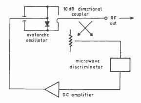
Fig. 1. — Boucle de contrôle automatique de fréquences pour oscillateur à avalanche.
