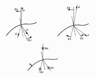
Fig. 6. — Conversion possible des modes à la frontière d'un corps solide.
