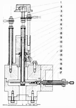
Fig. 3. — Cavité TM<sub>010</sub> brasée, dépôt électrolytique avec une anode tournante.
