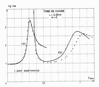
Fig. 43. — Temps de retard des modes  $F_{01}$  et  $E_{01}$  dans un tube de cuivre pour m=2; courbes théoriques et points expérimentaux.
