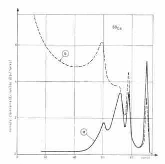
Fig. 5. — a) Spectre de <sup>60</sup>Co relevé en coîncidence avec les informations de temps.
