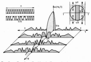
Fig. 7. — Fonction d'ambiguïté d'un code de phase pseudoaléatoire : étalement des lobes latéraux en fréquence.
