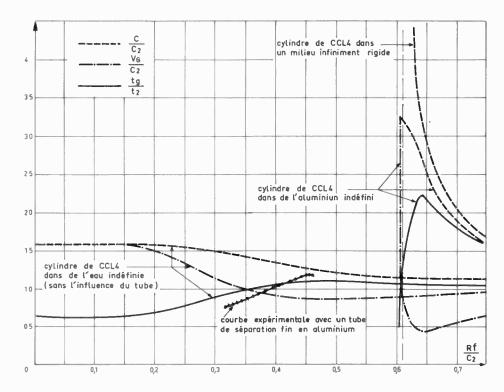
Fig. 36. — Courbes expérimentales de temps de retard d'un tube plongé dans de l'eau contenant différents liquides.
