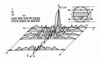
Fig. 6. — Fonction d'ambiguîté d'un code de phase pseudoaléatoire : étalement des lobes latéraux en distance.
