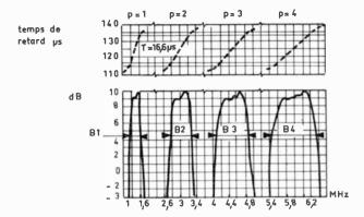
Fig. 26. — Courbes théoriques de la réponse en amplitude et du temps de retard en fonction de la fréquence pour les quatre premiers ordres d'une ligne à diffraction perpendiculaire.
