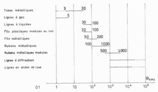
Fig. 49. — Domaines d'application des différentes lignes dispersives.
