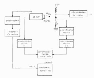
Fig. 3. — Dispositif de coîncidence comprenant une diode au germanium et un compteur à scintillations.
