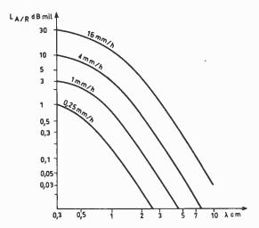
Fig. 6. — Atténuation due à la pluie (A/R dB mil)
