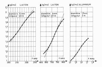
Fig. 16. — Courbes expérimentales du temps de retard dans un fil.
