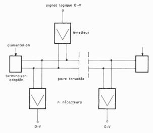
Fig. 11. — Système de transmission
