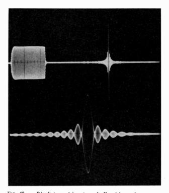
Fig. 48. — Résultats expérimentaux de l'expérience de compression d'impulsion relative aux courbes de la figure 47.
