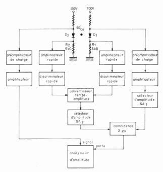
Fig. 8. — Montage de spectrométrie  $\gamma$  utilisant deux détecteurs Ge(Li) en coıncidence.
