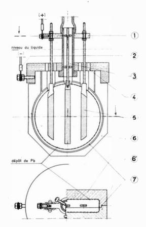
Fig. 2. — Cavité TM<sub>010</sub> brasée, dépôt électrolytique avec 3 anodes.
