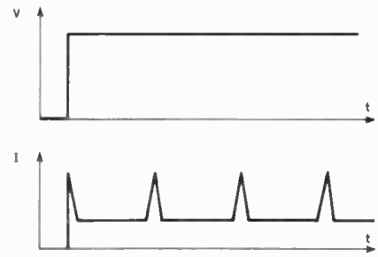
FIG. 8. — Allure de la tension et du courant d'effet Gunn en fonction du temps.
