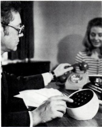
Relié à un poste téléphonique rotatif courant cet accessoire permet la numérotation abrégée et la numérotation par clavier (fabrication PYE-TMC).
