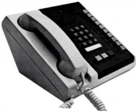
Poste téléphonique perfectionné destiné à être relié à un central téléphonique électronique privé. On distingue de gauche à droite : le haut-parleur permettant le « mains libres », le clavier de numérotation et enfin les touches fonctionnelles des services spéciaux (numérotation abrégée, conférences, etc.) (fabrication Northern Telecom).
