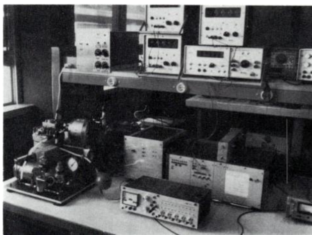
Fig. 5. — Actionneur : partie pneumatique et commande électronique.
