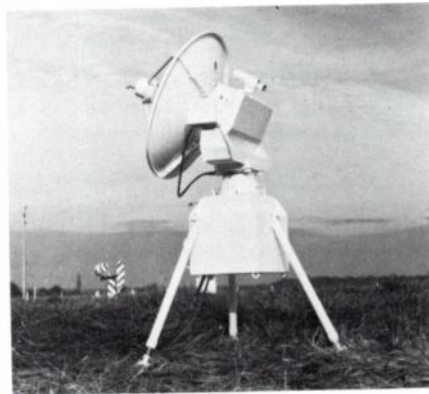
Radar météorologique de poursuite LCT type Zéphir.
