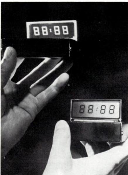
Système d'affichage par cristaux liquides. (Doc. Siemens)
