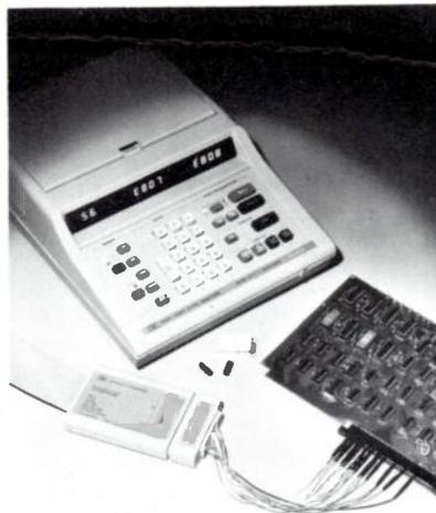
binaire et hexadécimal par exemple pour la visualisation de l'état des lignes de commande et des données. Il est également possible d'introduire des retards compris entre 0 et 65535 périodes d'horloge avant l'acquisition des données, ce qui facilite l'étude des boucles multiples. Au début de chaque mise en service, l'appareil s'assure lui-même de son bon état de fonctionnement par une séquence automatique de test.
