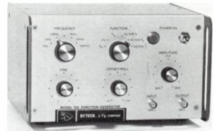
**Exact** : Générateur de fonctions-volubateur-générateur d'impulsions (fréquence maximale 50 MHz), modèle 757. [7766]
