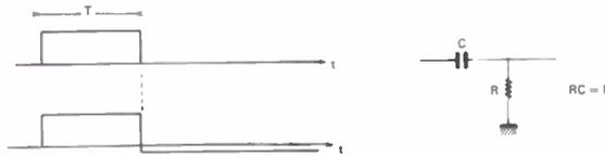
Fig. 1. — Transmission d'une impulsion par un passe-haut.
