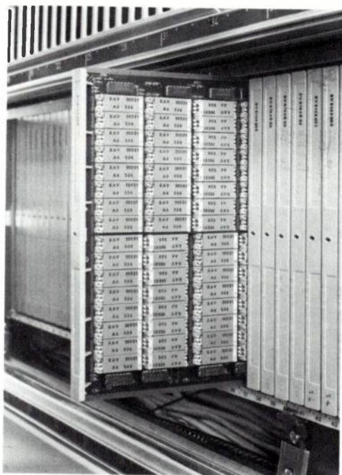
Fig. 4. — Matrice de relais à tiges.
