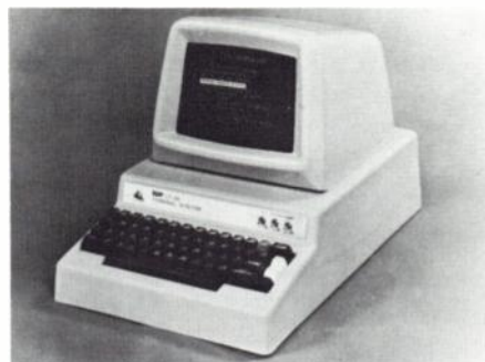
SWTP : équipement terminal de visualisation (16 lignes de 32 ou 64 caractères), modèle CT 64. [8897]
