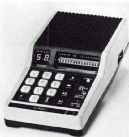
Composeur automatique de numéros d'appels téléphoniques Peritel (F) modèle C 400.
