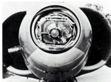
Télémètre laser avec chercheur de cibles installé dans le nez de l'avion Harrier (réalisation : Ferranti).
