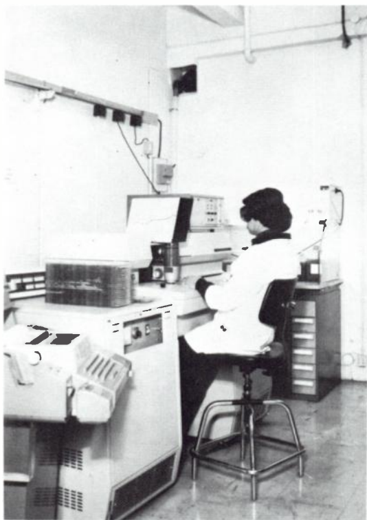
Fig. 3. — Vue de la machine automatique de découpe des pastilles de transistor par faisceau « laser ».
