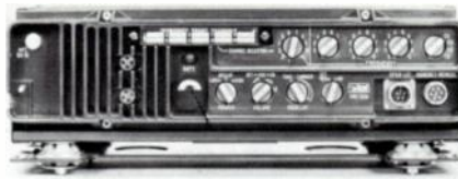
Émetteur - Récepteur pour télécommunications mobiles militaires, modèle VRC 538-T de la firme IRET. (20-70 ou 26-76 MHz ; 2000 canaux, FM)
