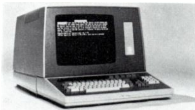
Beehive : équipement terminal à console de visualisation et à microprocesseur modèle B 500. [1009]
