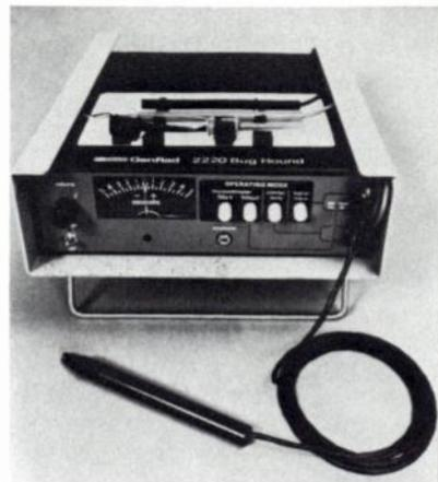
Le mode dit «de connexion» fait appel à un détecteur de résistivité à seuil. Lorsque la portion de circuit située entre deux sondes présente une résistance inférieure à  $68\Omega$ , il y a production d'un signal acoustique sur le haut-parleur de l'appareil.
