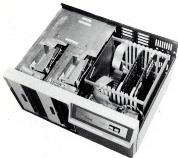
Fig. 4. — Le microordinateur MCZ est constitué par des cartes de la famille, telle que celle décrite plus haut. L'utilisateur n'a plus à se soucier du coffret, des alimentations et de certains périphériques. Pour résoudre son application, il n'a plus qu'à se concentrer sur les périphériques et les capteurs spécifiques du système.
