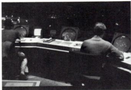
Console radar affectée aux images fournies par le nouveau radar de surveillance au sol «Astre» équipant la tour de contrôle de Roissy-Charles de Gaulle.
