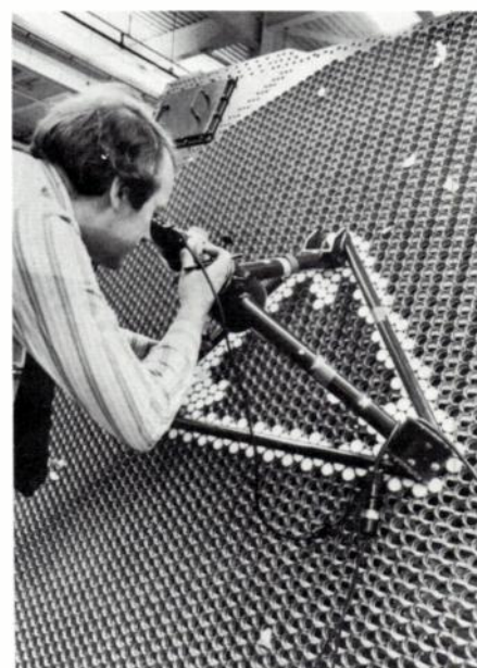
Assemblage de l'antenne de radar à balayage électronique du système de défense aérienne américain «Patriot» (Doc. Raytheon).
